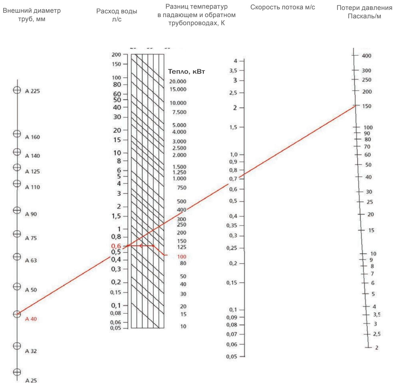
**Красным цветом обозначен пример расчета для тепловой мощности 100 кВт и разница температур в подающем и обратном трубопроводах 25 Кельвинов (°C) (при температурном режиме 95/70)**
